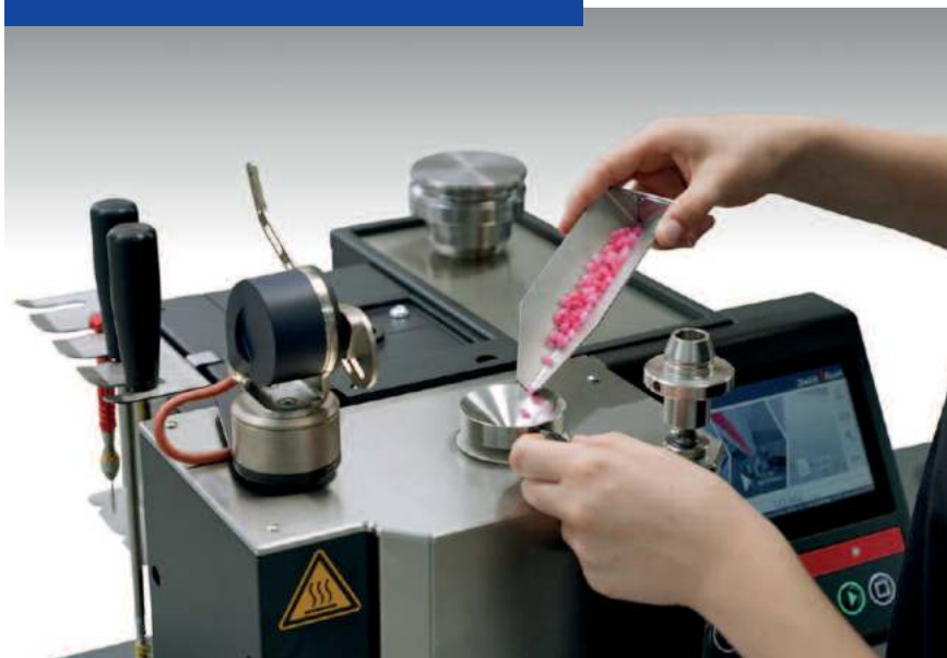
Einfüllen und prüfen von Kunststoff-Granulat
