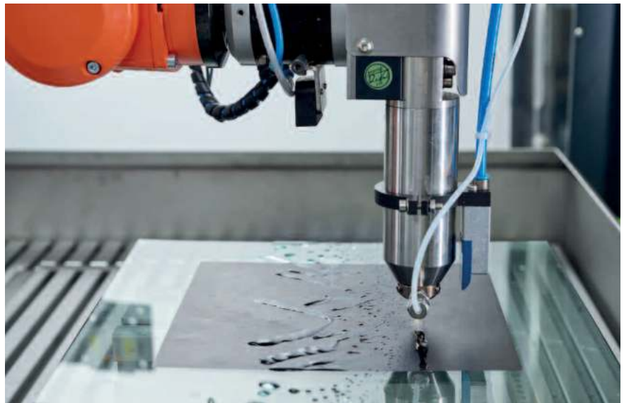
Weltneuheit HydroPlasma: Schonende, intensive und effiziente Entfernung hartnäckiger Rückstände auf Glas-, Metall- und Kunststoffoberflächen (Copyright: Plasmatreteat GmbH)
