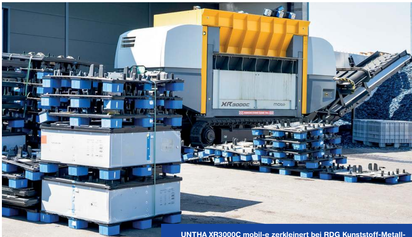
UNTHA XR3000C mobil-e zerkleinert bei RDG Kunststoff-Metall-Verbunde (Alle Bilder: UNTHA shredding technology GmbH)
